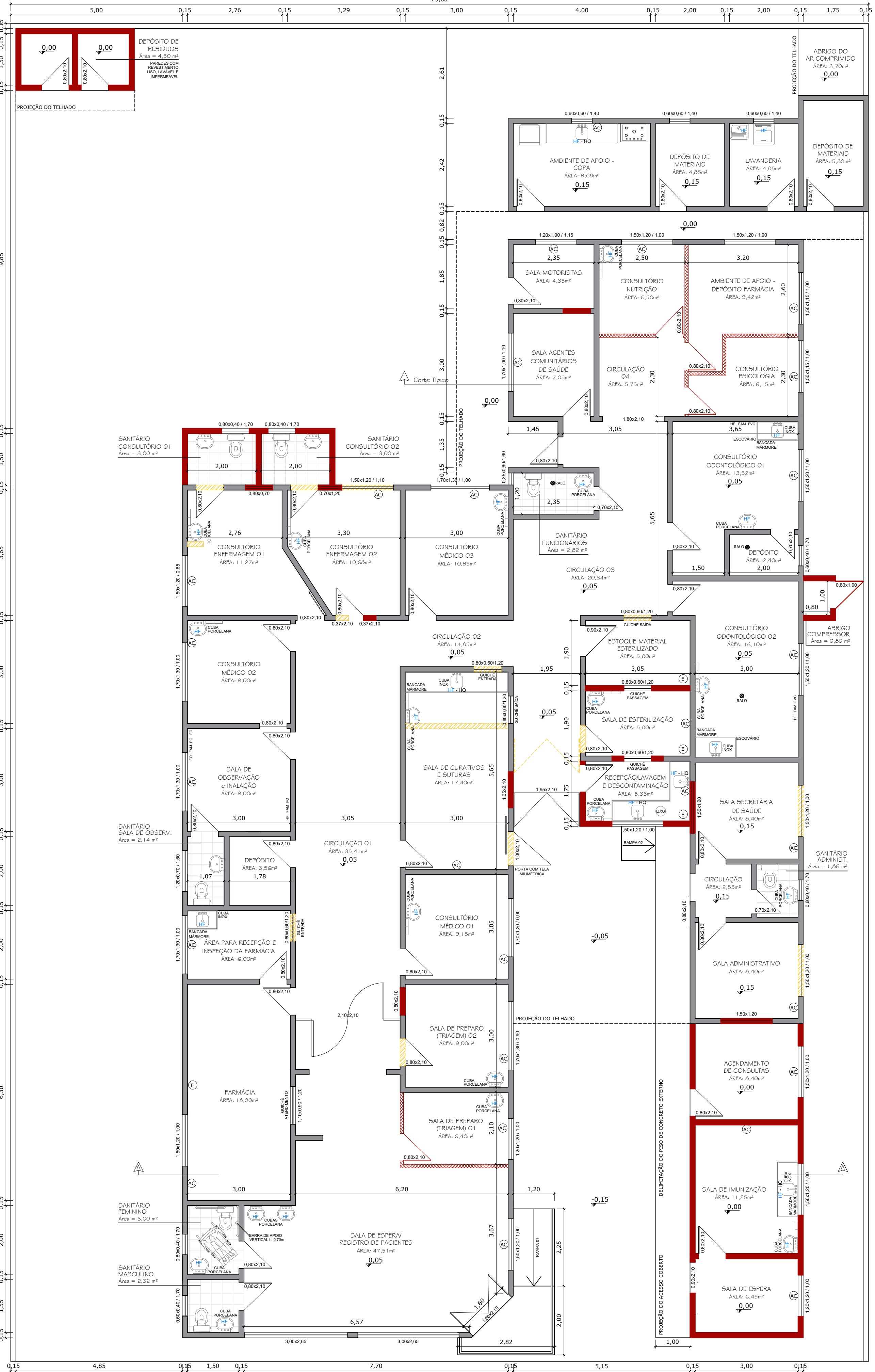
PLANTA BAIXA TÉCNICA - UNIDADE BÁSICA DE SAÚDE ESCALA 1/50
